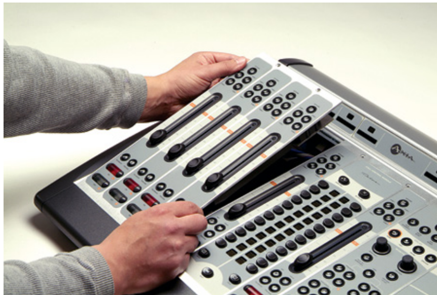
Figura C-15: Modulo inclinado para ser retirado
