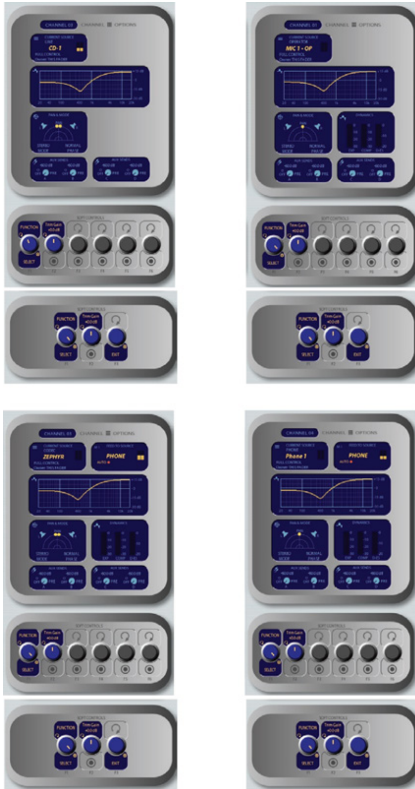
Figura 5-7: Pantallazo de Channel Options. La información desplegada difiere basado en el tipo de fuente actualmente asignada al fader activo. Mostrado como agujas de reloj en la parte superior izquierda: Opciones de Fuente de Canal de línea, Opciones de Canal de Fuentes de Micrófono, Opciones de Canal de Fuente Telefónica, Opciones de Canal de Fuente Códec. Los controles de 2-fader se muestran a continuación.
