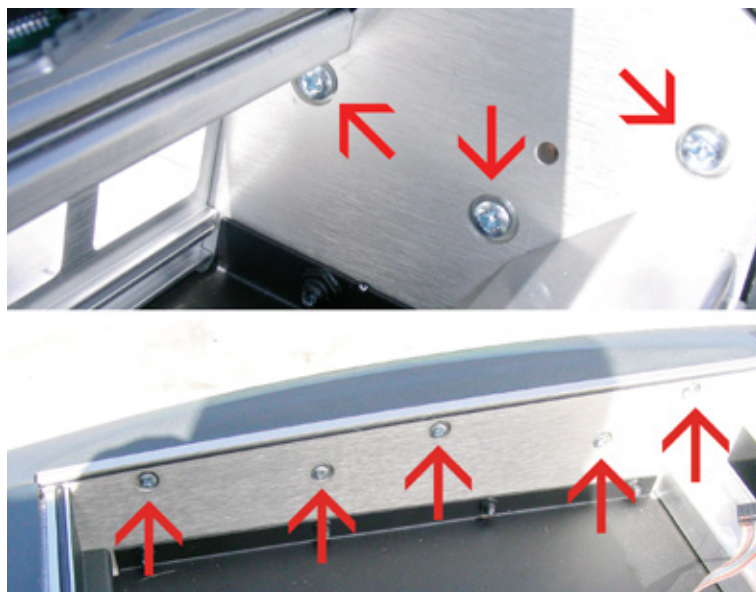
Figura C-8: Ubicación de los tornillos de fijación final en el compartimiento de la estructura (arriba) y (abajo).
