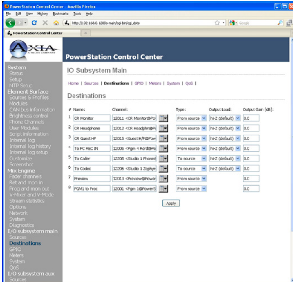
Figura 3-7: Pantalla "Destinations" de la unidad PowerStation I/O
