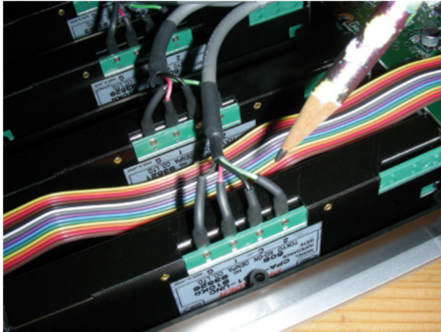
Figura C-16: Retire el cable conector del fader
