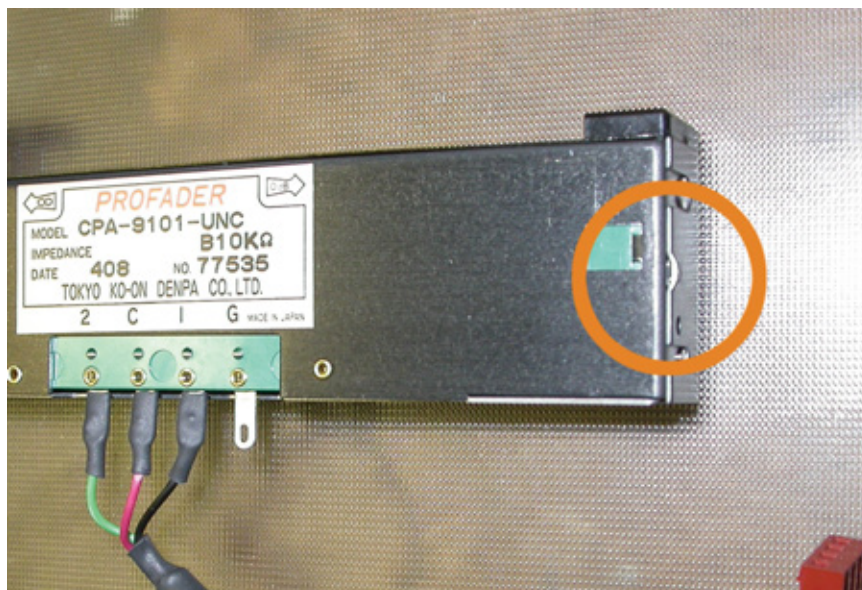
Figura C-17: Punto de agarre en la cubierta del fader
