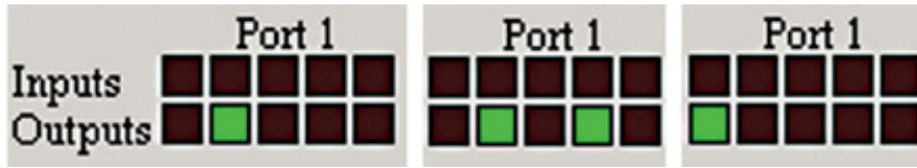
Figura 4-3: Indicadores mostrando la actividad del puerto GPIO
