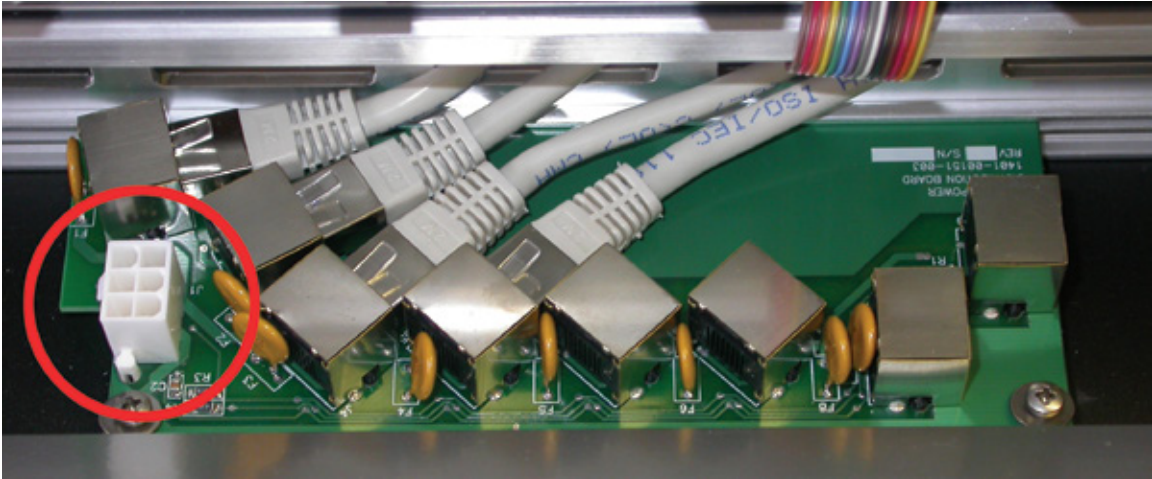
Figura 1-5: Panel de conexión de Element. El conector dentro del círculo es para el cable de datos y energía; el RJ-45 conecta los faders y los módulos accesorios.
